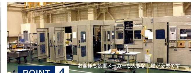
最高のクリーン度を保つクラス1000フロアに各FO工程装置とモールド装置が同居
