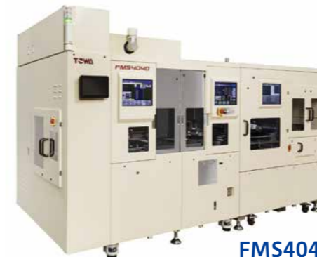
ハブレスブレード交換作業などの自動化・省人化・品質向上に貢献する新規開発シンギュレーション装置
